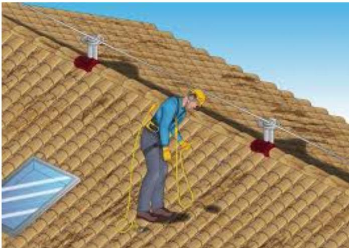
**tipo C, dispositivo di ancoraggio (temporaneo e rimovibile) che impiega una linea flessibile di ancoraggio che devia dall'orizzontale non più di 15°,
